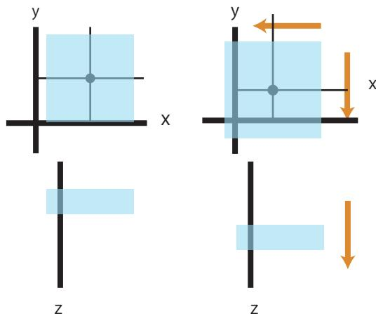
台座をのせた棒を x 軸 y 軸で制御して動かし、とぐろを巻く動きをつくり、そのまま下に台座ごと下げていきます。
