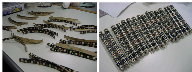
リールのテープ状LEDリボンを稜線バルサ材4面に全て貼り付ける
