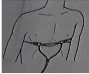
図21 呼吸センサの取り付け方
