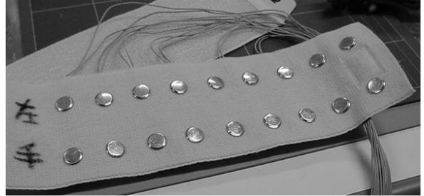
図8 MiniBioMuse-IIIの電極ベルト部分
