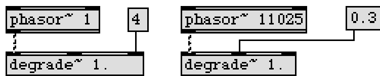
シグナルのサンプリング・レートや量子化ビット数を変更する
