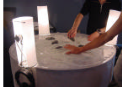
図26. 作品 "Augmented Garden" 「箱庭」のように砂と砂利を置き、これを来場者が手でこね回す動作をセンシングしてサウンドを生成する。
